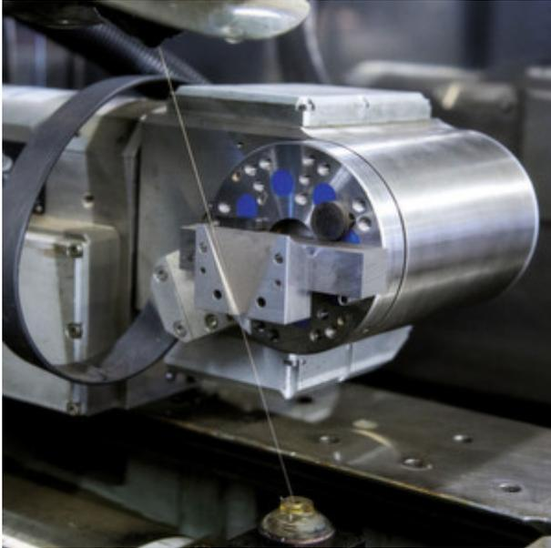
Zur Herstellung von Kleinteilen aus Metall kommt eine Draht-erodiermaschine zum Einsatz. Für optimale Erodiervorgänge sorgt im Vorfeld eine NC-Programmierung speziell für die Drahterosion. (Bild: Niki Romczyk)
