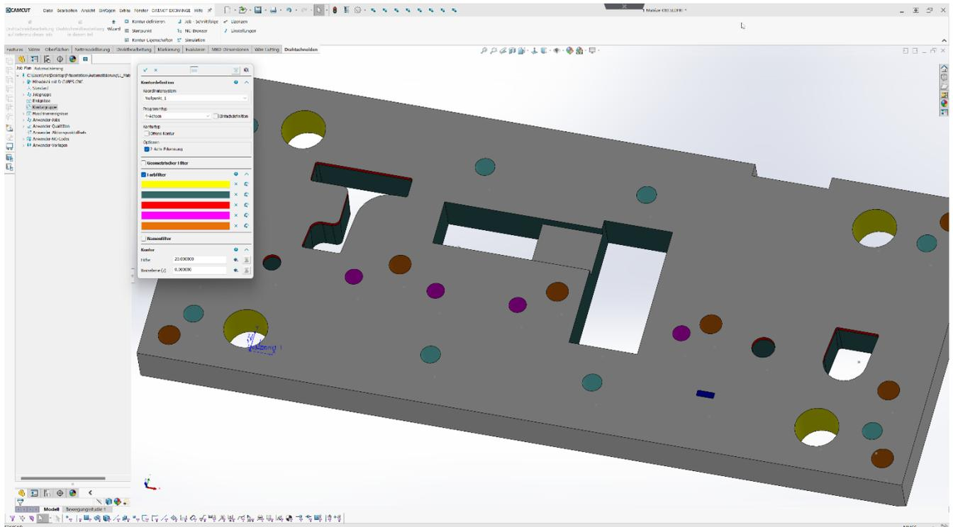
Neu ist die Konturerstellung mit mehreren Farben. So können mit dem Farbfilter gleichzeitig mehrere offene und geschlossene Konturen erstellt werden. Die erstellten Konturen behalten als DCAMCUT Kontur ihre Farbe bei.
