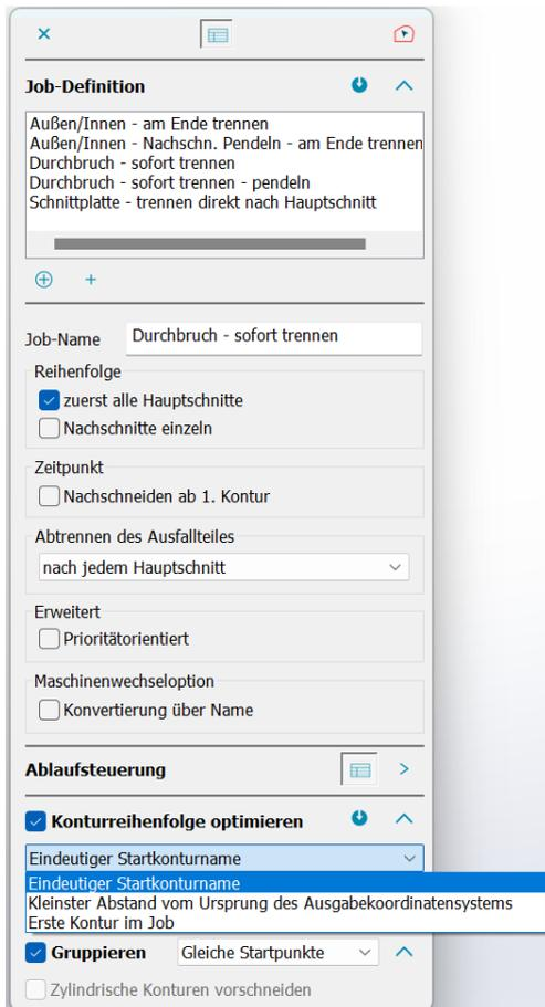
In der Job-Schnittfolge kann die Reihenfolge von Konturen automatisch optimiert werden. Dabei wird die kürzeste Positionierbewegung erzeugt.
